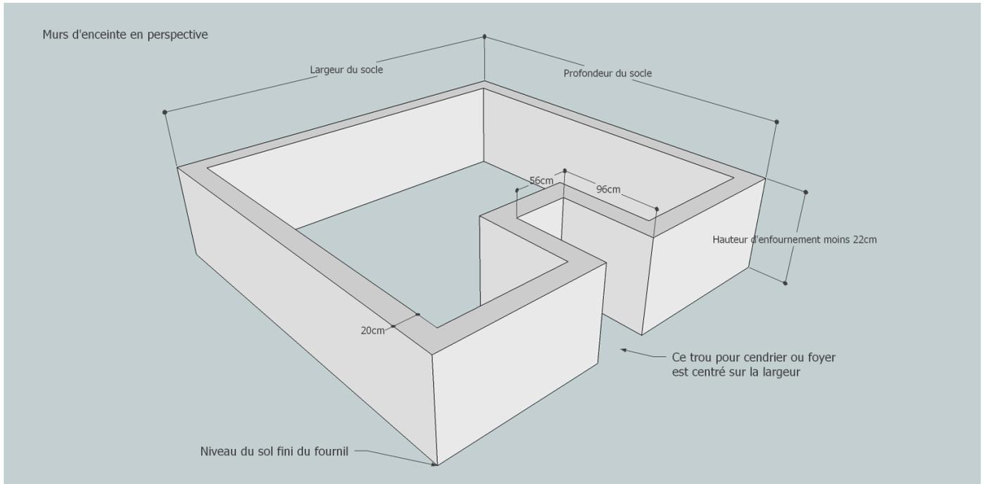
Vous constaterez que le niveau du socle terminé est 7 cm en-dessous du niveau d'enfournement. Cette différence correspond à l'épaisseur du mortier + celle des carreaux de sole qui seront posés dessus.
